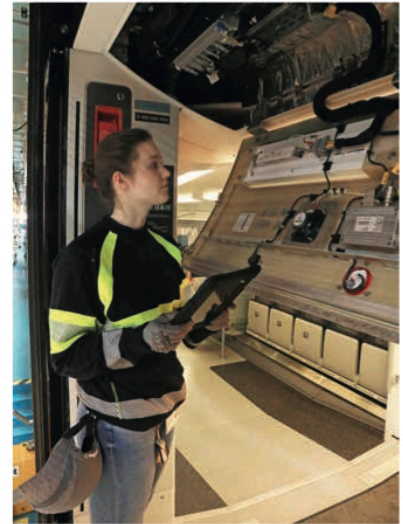
Sicherheitsrelevante Tätigkeit: Überprüfung der Türsteuerung beim RRX-Fahrzeug
