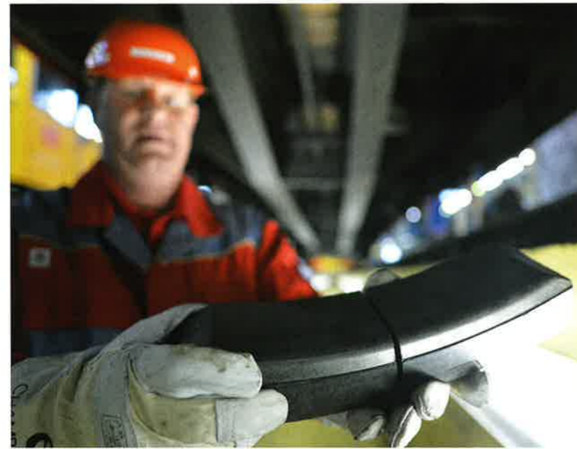
Anfang 2018 meldeten die privaten Wagenhalter, dass 70,65 Prozent ihrer Wagen mit den sogenannten Flüsterbremsen ausgerüstet sind. Bei der DB Cargo betrifft das zwei Drittel des 60.000 Wagen umfassenden Bestandes.
