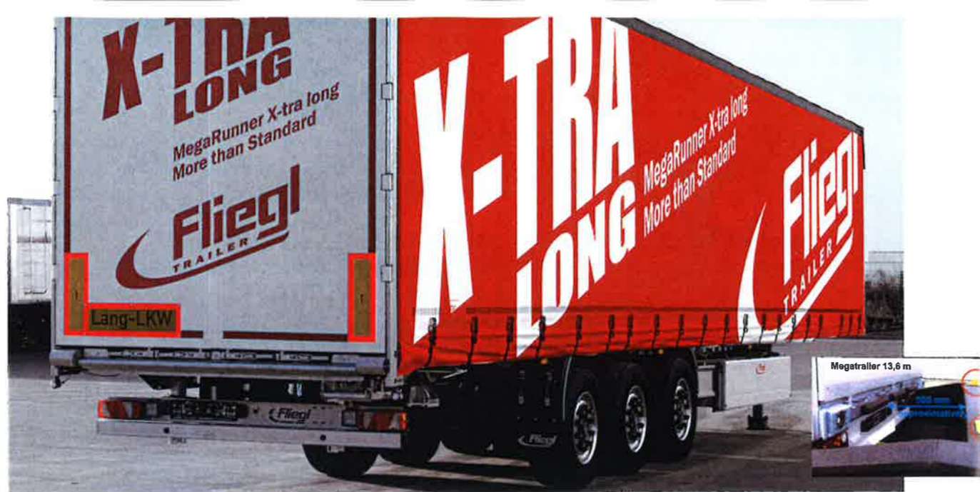
Moderner Sattelanhänger der Fliegl-Gruppe: Er ist statt 13,60 Meter 14,90 Meter lang und dadurch als Typ 1 nicht kombiverkehrstauglich. Die kleine Abbildung zeigt den Unterschied zum derzeit üblichen Auflieger.
