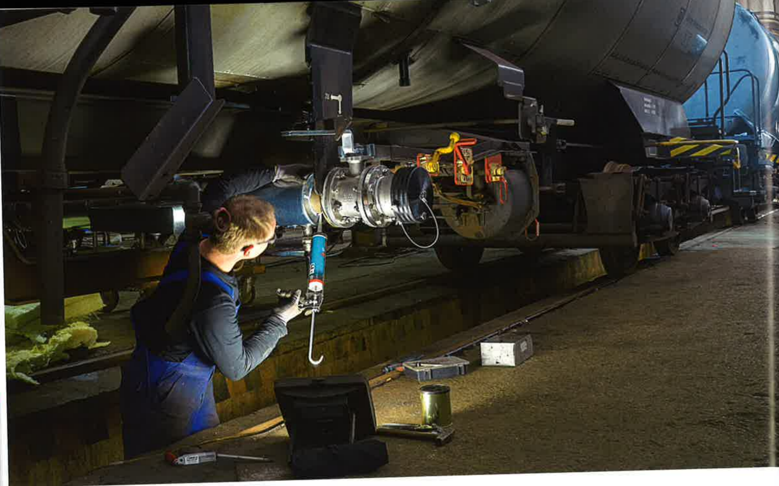
Armaturenmontage an einem Kesselwagen.
