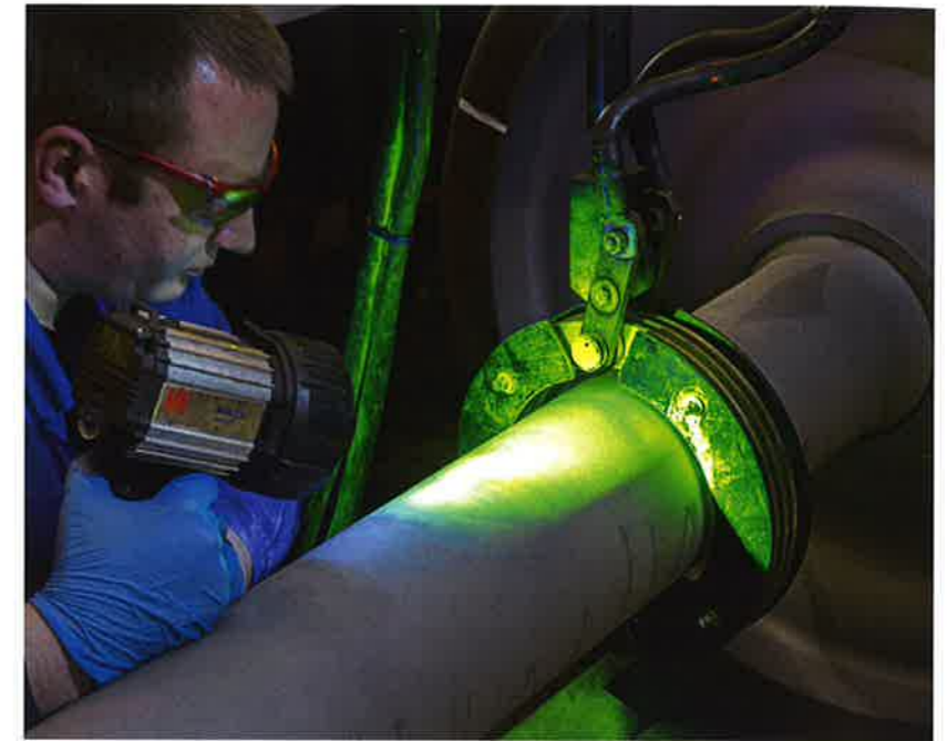
Zerstörungsfreie Prüfung einer Radsatzwelle mittels Magnetpulverprüfung.
