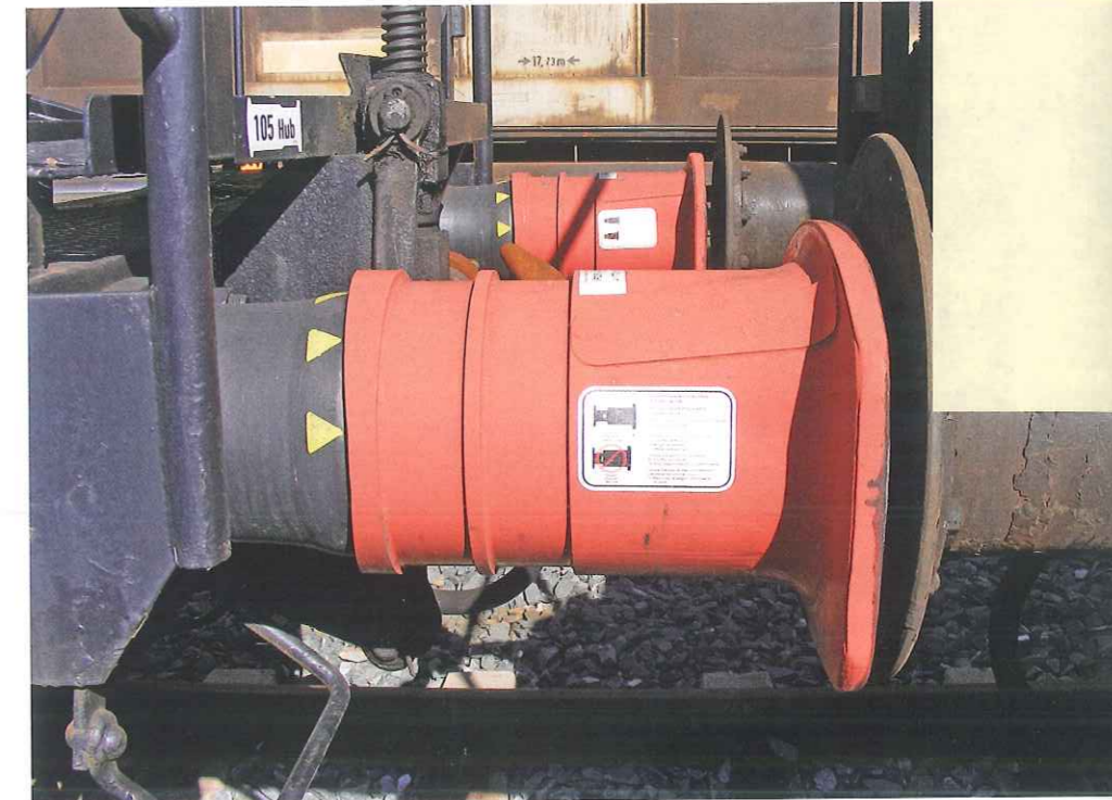
Crashpuffer sind bei Wagen im Gefahrguttransport vorgeschrieben.
